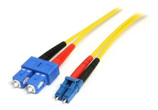
Das 1 m lange LC-auf-SC-Single Mode Duplex-LWL-Kabel SMFIBLCSC1 verfügt über eine 9/125-Mikron-LWL für äußerst schnelle Datenübertragungen mit hoher Bandbreite über Gigabit-Ethernet- und Fiber Channel-Netzwerke mit Unterstützung für Duplex-Single Mode-Anwendungen.
