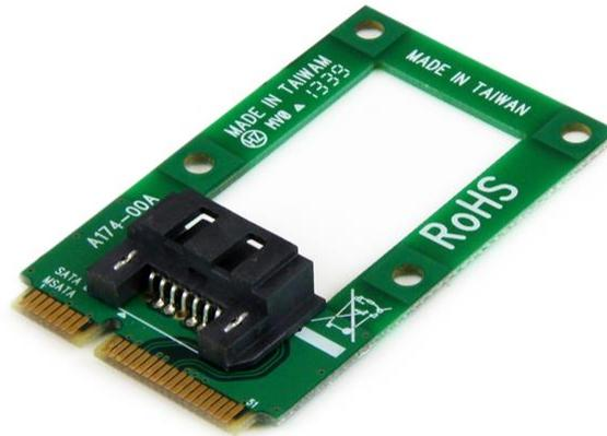
Mit dem mSATA-auf-SATA-Adapter MSAT2SAT3 können Sie eine standardmäßige SATA-Festplatte an einen verfügbaren mSATA-Port anschließen.
