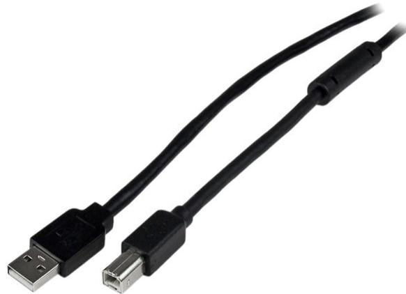
Das 20 m lange USB A-auf-B-Kabel USB2HAB65AC enthält bus-betriebene aktive Schaltkreise, sodass es über die Reichweite von 5 Metern eines standardmäßigen USB-Kabels hinaus funktioniert.
