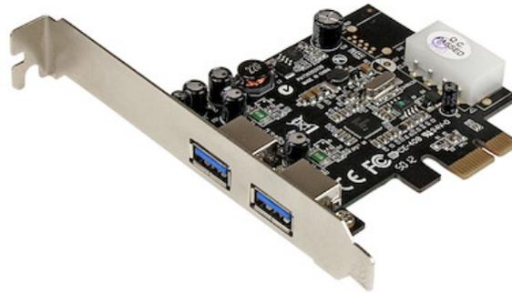
Mit der 2-Port-PCI Express USB 3.0-Karte PEXUSB3S25 können Sie zwei USB 3.0-Ports zu einem PCI Express-fähigen Computersystem hinzufügen. Mit optionalem LP4-Stromanschluss zum Anschließen der Stromversorgung des Systems und Bereitstellen von bis zu 900 mA Strom per Port für USB 3.0-betriebene Geräte (500 mA für USB 2.0).
