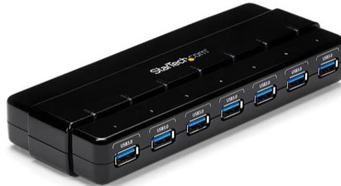
Mit dem USB 3.0-Hub ST7300USB3B können Sie einem Computer über eine einzige USB 3.0-Hostverbindung sieben externe USB 3.0-Ports hinzufügen.
