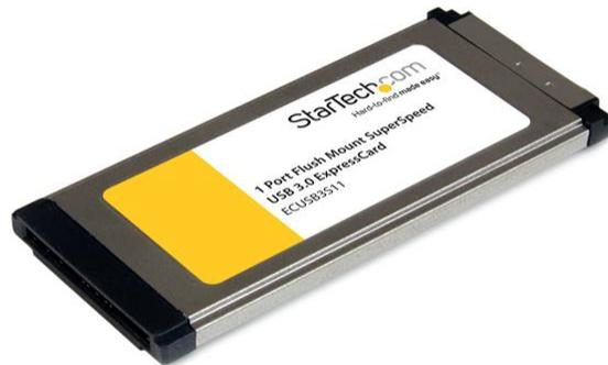
Mit der bündig eingebauten 1-Port-USB 3.0-ExpressCard-Karte ECUSB3S11 können Sie einem Laptop über einen ExpressCard-Steckplatz einen einzigen USB 3.0-Anschluss hinzufügen.
