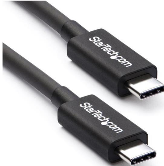
Dieses Thunderbolt™ 3-Kabel (40 Gbit/s) können Sie an jeden Thunderbolt 3 (USB-C™)-Anschluss anschließen, um Video und Daten für Thunderbolt- und USB-Geräte bereitzustellen. Zudem bietet das Kabel Stromversorgung zum Laden Ihrer Geräte, und Sie können bis zu sechs Thunderbolt 3-Geräte in Reihenschaltung verbinden.
