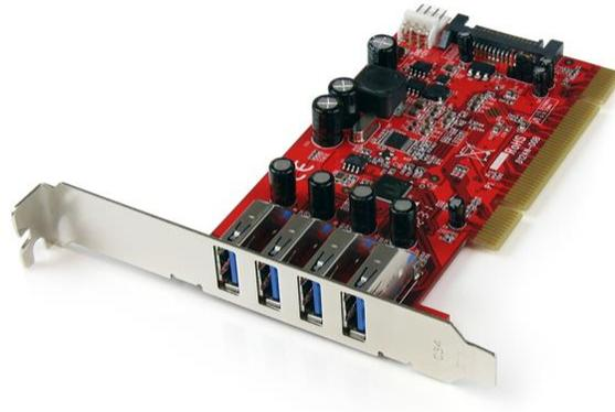
Mit der 4-Port-PCI-auf-USB 3.0-Karte PCIUSB3S4 können ältere PCI-Steckplätze den SuperSpeed USB 3.0-Standard unterstützen, der für Datenübertragungsraten von bis zu 5 Gbit/s geeignet ist. Bei Verwendung von USB 3.0-Geräten mit dieser Karte erhöhen sich die Datenübertragungsraten auf bis zu 1,3 Gbit/s der verfügbaren Bandbreite (PCI-Bus-Limit). Das entspricht mehr als der doppelten Leistung im Vergleich zu einem USB 2.0-Anschluss.
