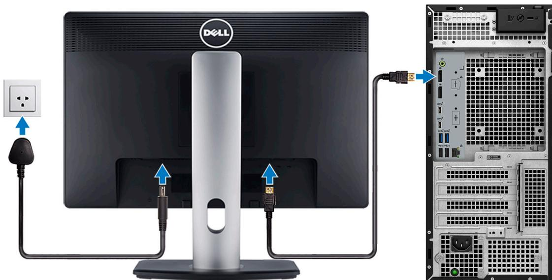
**ANMERKUNG:** Wenn Sie Ihren Computer mit einer separaten Grafikkarte bestellt haben, sind der HDMI-Anschluss und die Bildschirmanschlüsse auf der Rückseite Ihres Computers abgedeckt. Schließen Sie das Display an den Anschluss der separaten Grafikkarte an.
