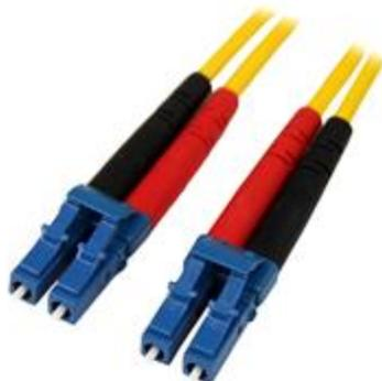
Das 7 m lange LC-auf-LC-Single Mode Duplex-LWL-Kabel SMFIBLCLC7 verfügt über eine 9/125-Mikron-LWL für äußerst schnelle Datenübertragungen mit hoher Bandbreite über Gigabit-Ethernet- und Fiber Channel-Netzwerke mit Unterstützung für Duplex-Single Mode-Anwendungen.
