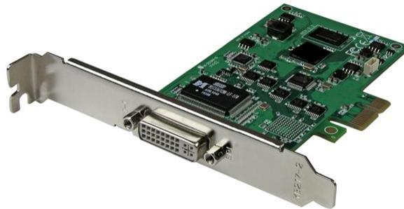
Mit Hilfe dieser All-in-one-PCI Express-Aufnahmekarte können Sie 1080p-HD-Video und Stereo-Audio auf Ihrem Computersystem aufnehmen. Dank mehrerer Videoeingänge, einschließlich HDMI, DVI, VGA und Component, kann die Aufnahmekarte Originalinhalte von verschiedenen Quellen wie Computern, Camcordern, Sicherheitssystemen, Kassenterminals und Servern aufnehmen. Dank H.264-Codierung ist sie die perfekte Lösung zum Aufnehmen von High Definition Video zum Bearbeiten, Kompilieren und Archivieren.
