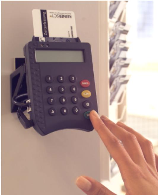
Bei der Montage ist darauf zu achten, dass das Gerät nur in geschützten Innenräumen zum Einsatz kommt. Feuchte oder stark staubhaltige Umgebungen sind zu vermeiden!
