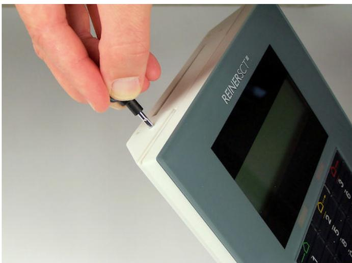
Um die Montage zu erleichtern, können Sie den Deckel von der Geräterückseite trennen. Dazu müssen Sie die Laschen an der Rückseite mit den beiden Daumen nach innen drücken und dabei die Rückseite nach vorne bewegen und somit aus der Arretierung lösen.
