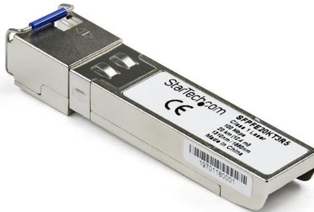
Der SFPFE20KT3R5 ist ein Juniper SFP-FE20KT13R15-kompatibles Glasfaser SFP-Transceiver-Modul, das für den Einsatz mit Juniper® Marken-Switches und -Routern entwickelt, programmiert und getestet wurde. Es sorgt für zuverlässige 0.1 GbE-Konnektivität über Glasfaser-Kabel für 100Base-BX10-U-konforme Netzwerke mit einer maximalen Entfernung von bis zu 20 km.
