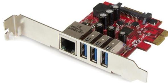
Diese PCIe USB 3.0-Karte vereint Verbindungen mit Peripheriegeräten und Netzwerk in einer einzigen skalierbaren Lösung
